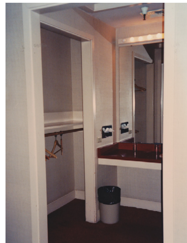
Foto : Hotel Asilomar, Monterey, California. Habitación accesible: una solución sencilla y económica para el guardado de la ropa y el uso de los lavatorios
