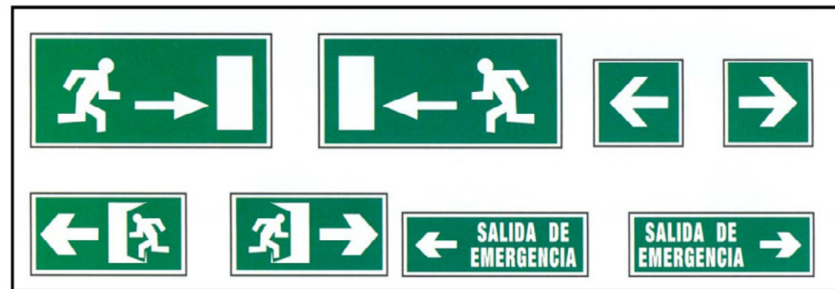
Figura 14. Señalización de vía de evacuación a seguir hacia el exterior.
